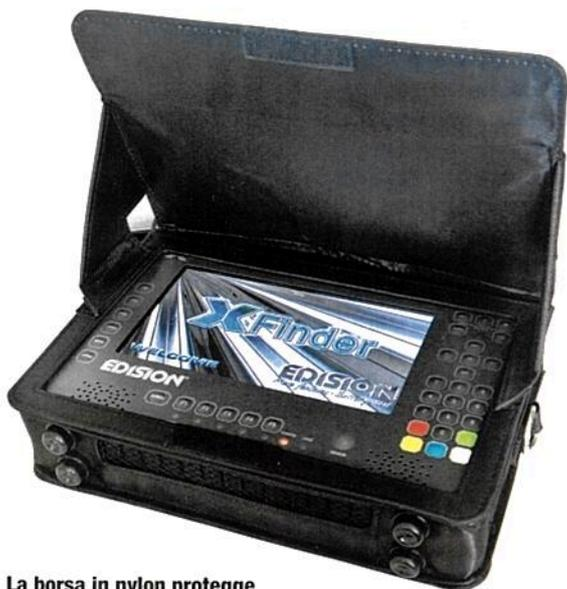
La borsa in nylon protegge lo strumento da urti, graffi e sporcizia. Il lato superiore funge sia da parasole grazie alle alette con fissaggio velcro, sia da stampella per mantenere l'inclinazione ottimale
